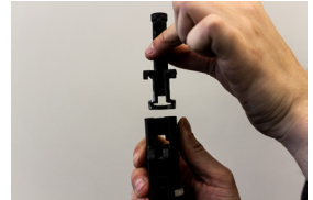
Aseta uusi ohjain ja kiinnitä huomiota ohjauksielekkeiden suuntaan.
