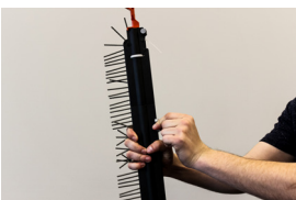
Pidä työkalun runkoa yhdellä kädellä niin, että ruuvit pysyvät paikallaan
